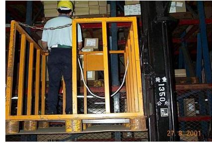
(六)堆高機駕駛就定位，並開始徐緩上升作業：：駕駛人員應確認堆高機已於行駛停止狀態，並拉手煞車固定車身後，方得進行操作腳叉上升或下降，絕對禁止堆高機於行進間同時一邊操作腳叉昇高或下降。
